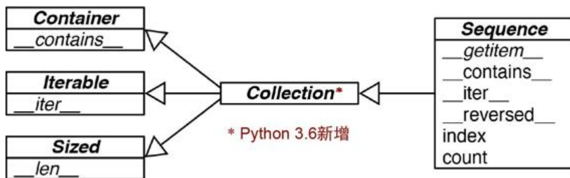
图 13-2: Sequence 抽象基类和 collections.abc 中相关抽象类的 UML 类图。箭头由子类指向超类。以斜体显示的是抽象方法。Python 3.6 之前的版本中没有 Collection 抽象基类, Sequence 是 Container、Iterable 和 Sized 的直接子类
